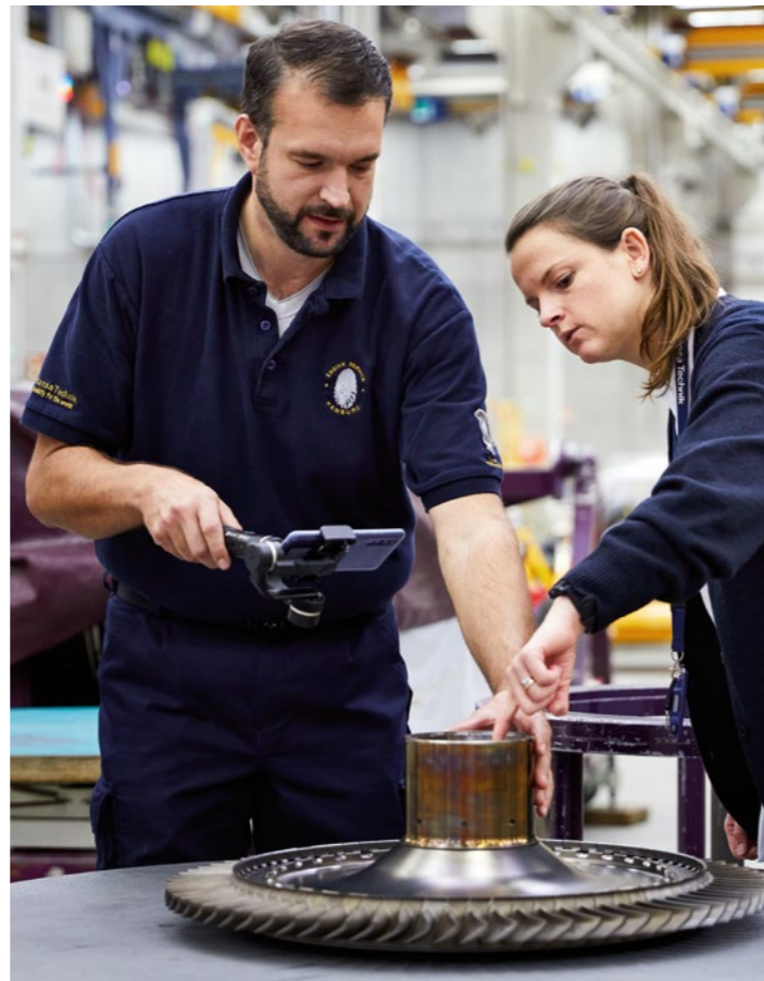
Vorarbeiter Helge Arand und Projektleiterin Wiebke Hubert stehen bei der „Virtual Table Inspection“: Sie inspizieren und filmen Triebwerksteile – Kunden können dann Reparaturen direkt im Videochat beauftragen.
